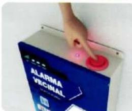
a) Oprima el BOTÓN ROJO y déjelo oprimido hasta que el foco iluminador rojo deje de parpadear y se quede encendido (adicionalmente escuchará 3 bips).
